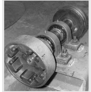
Figure 33 :Accouplement si le moteur utilisé n'a qu'une faible résistance radiale
