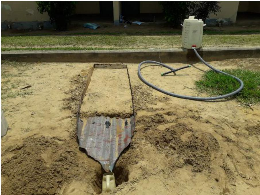
FIGURE 21: *Simulateur de pluie utilisé pour la détermination de la capacité d'infiltration*
