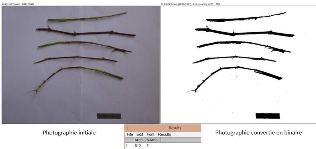
FIGURE 20: Principe de détermination des surfaces de tiges via le logiciel ImageJ. A gauche : photographie initiale. A droite : photographie convertie en image binaire.
