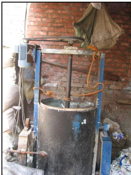
Graisser souvent les pièces tournantes de la machine, notamment les roulements. Protéger le moteur électrique et les interrupteurs des projections d'eau pour éviter grippage des pièces, les court-circuit et électrocution
