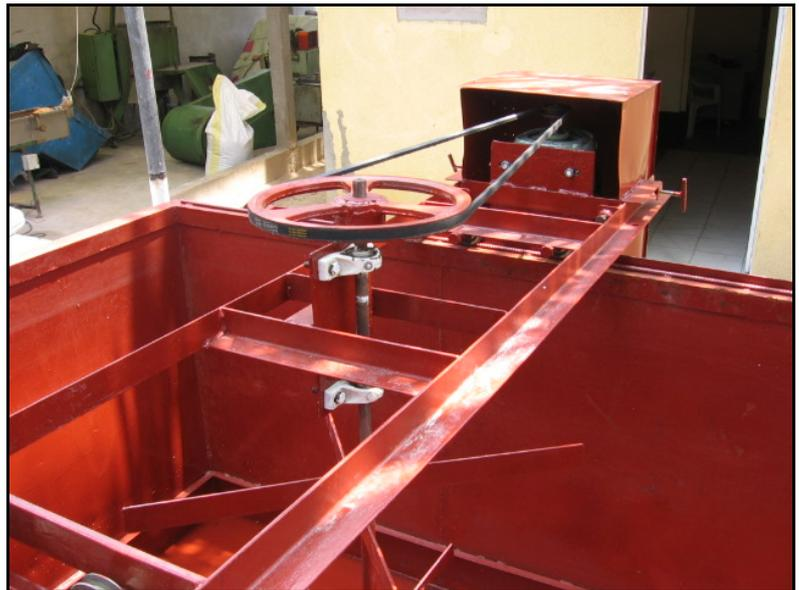
Le moteur du malaxeur a besoin d'une puissance d'environ 2 CV, la vitesse de rotation de l'hélice tourne entre 50 et 100 tours/minutes pour un brassage efficace
