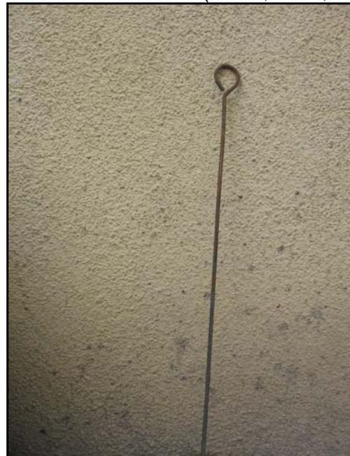
Fabriqué avec fer à béton de 6mm de diamètre, coupé à 1 m environ, un bout recourbé (poignée) et un bout pointu (à la meule) avec un point de soudure en forme de petite boule placé 5 cm au-dessus de la pointe pour empêcher glissement plastique
