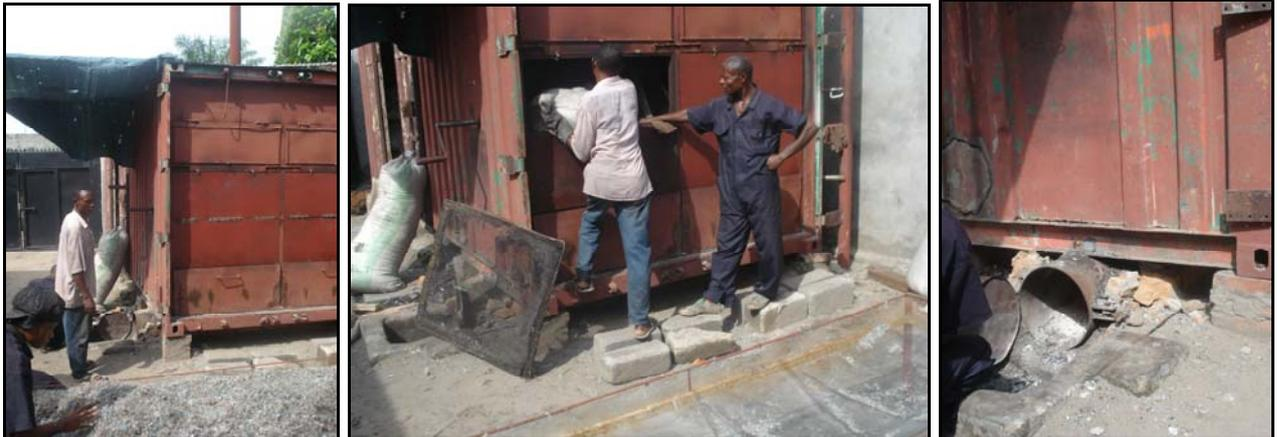
A mi-hauteur du caisson, un axe sur lequel tournent comme une broche, deux "cages" (100cmsX80X80). Ces cages sont faites avec une structure légère en barre à béton, parois en treillis à lapin recouvert de toile de moustiquaire--> bon marché), dans lesquelles nous mettons les plastiques à sécher. Portes d'alimentation des paniers en haut, tiroirs de récupération des plastiques en as
