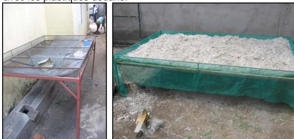
Les mailles offrent une ventilation du bas vers le haut, facilitant l'évaporation et l'eau passe tombe par terre à travers elles. Elle s'évapore également vers le dessus par l'effet de la chaleur sur la surface supérieure des plastiques. La hauteur des tables permet aux opérateurs d'être à bonne hauteur de remuer de temps en temps les plastiques pour les décoller les uns des autres et faciliter leur ventilation.
