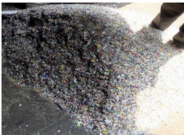
Le broyage est une étape de préparation coûteuse, notamment en énergie. Dans la figure 2.8 les déchets broyés sont étalés au sol avant d'être mis dans des sacs à raphia de 25 Kg chacun pour la prochaine étape réservée au lavage.
