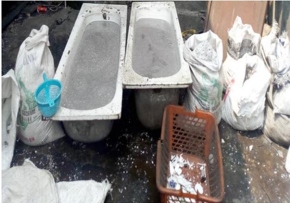
Les plastiques broyés comme vu dans la figure 2.9 sont ensuite lavés dans cuves avec de l'eau du robinet et des détergents (savon liquide). Après le lavage les copeaux sont mis dans des sacs à raphia de 25Kg, ce que la figure 2.10 montre.
