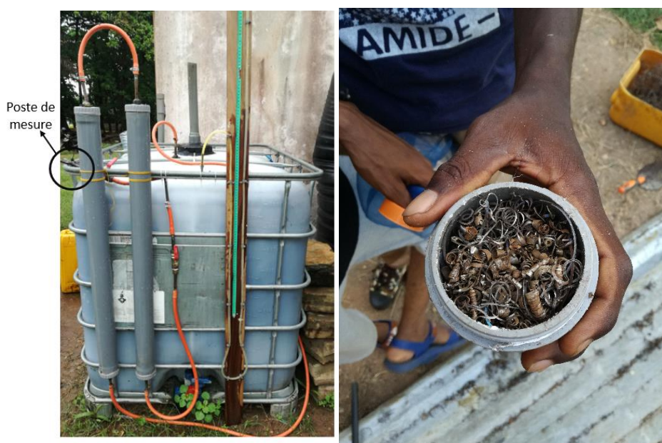
Figure 54: Filtre à H_2S créé lors du travail précédent [Réf. (9)]
