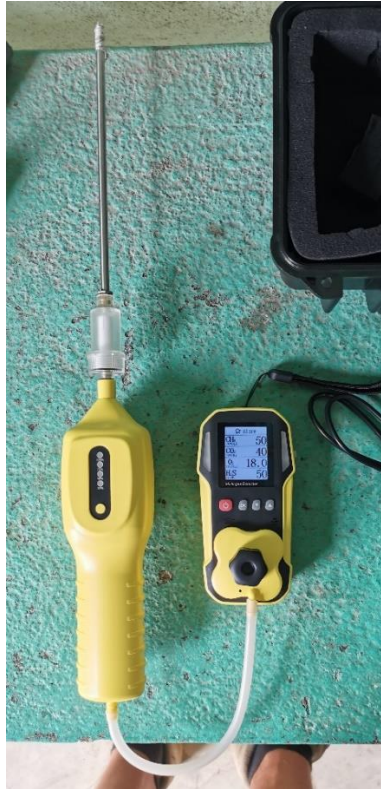
Figure 44: Montage de l'IRCD4 et affichage post initialisation
