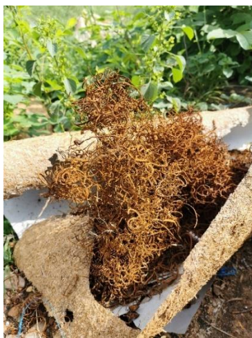
Figure 57: Limaille de fer jaunie par le soufre
