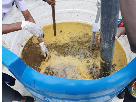
Figure 34: Homogénéisation du contenu du biodigesteur
