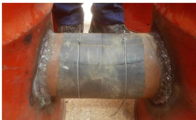
*Figure 31 : Dispositif de jonction de deux fûts*
