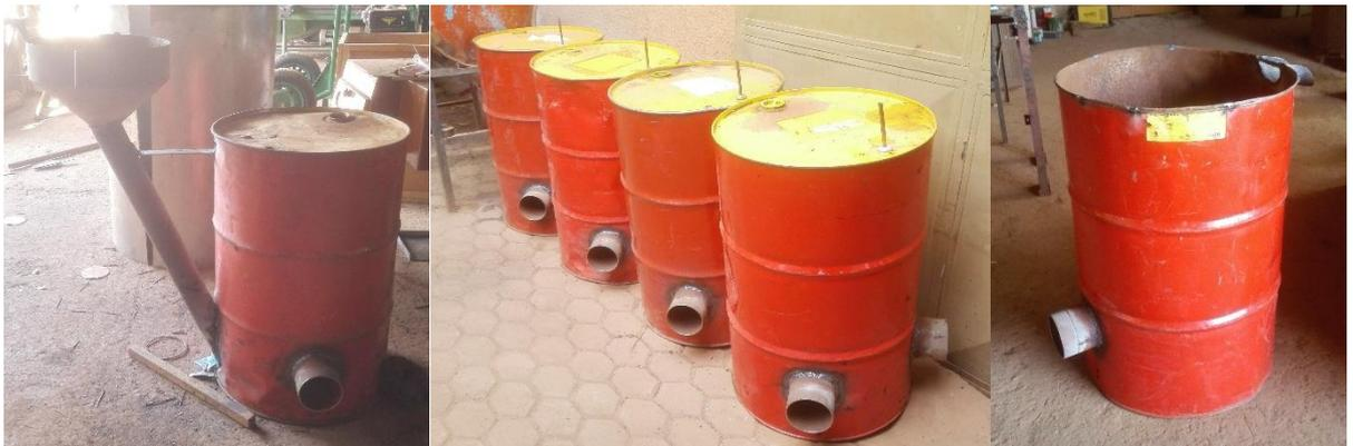
*Figure 29 : Photo des différentes barriques ; respectivement barrique d'alimentation, barriques intermédiaires et barrique d'évacuation*
