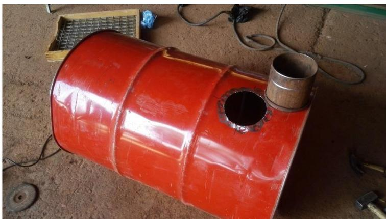
*Figure 27 : Préparation d'un des fûts du digesteur modulaire*
