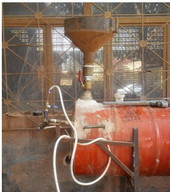
Figure 17 : Système d'alimentation du digesteur à 5 fûts
