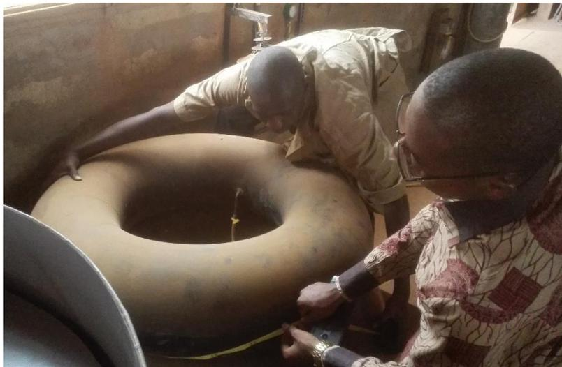
*Figure 21 : Mesure des chambres à air contenant la production de biogaz*
