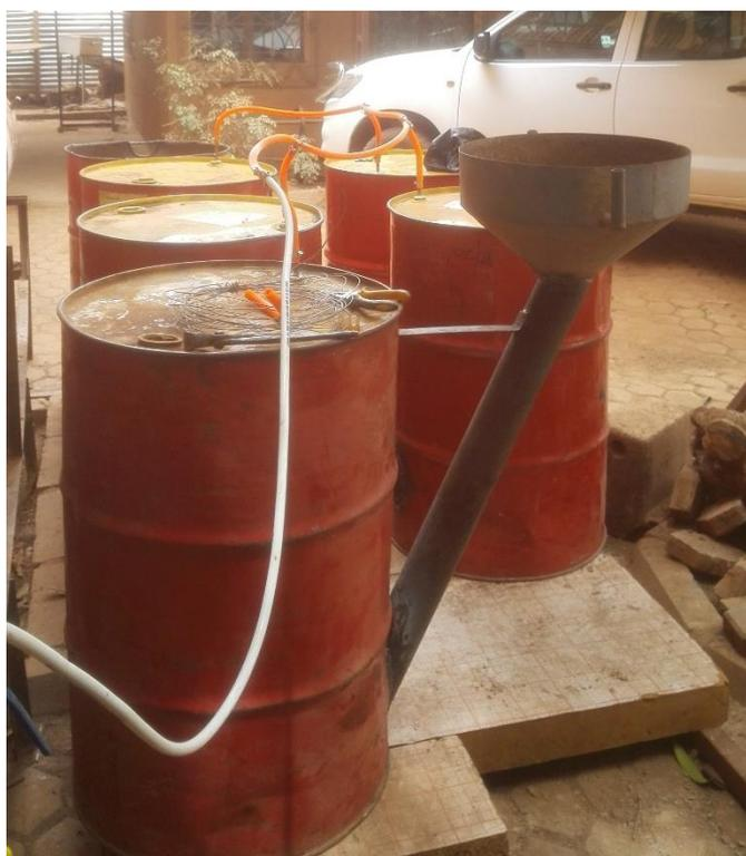
Figure 32 : Digesteur modulable prêt pour l'expérimentation
