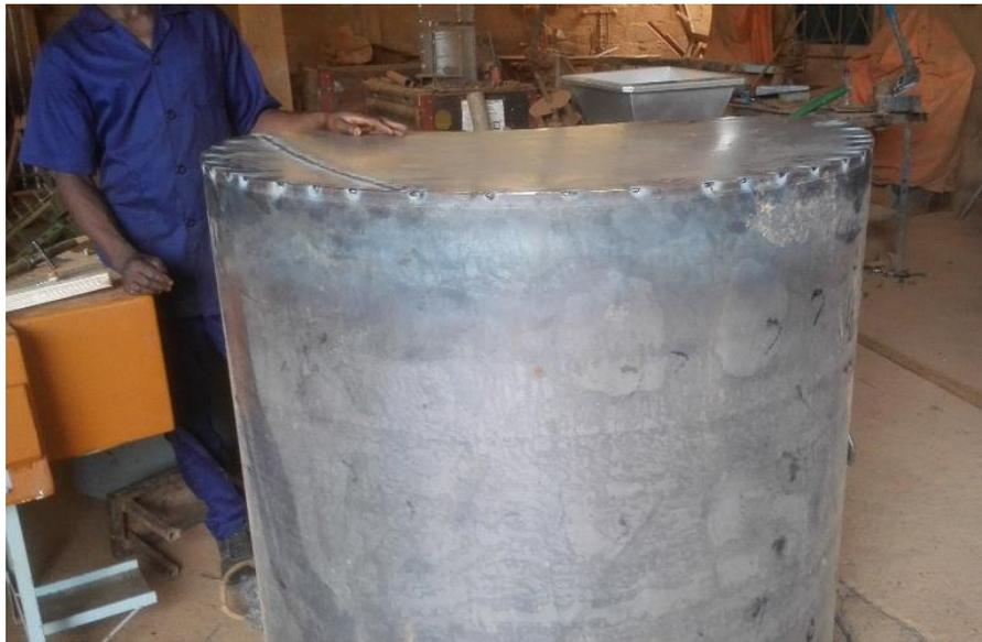
*Figure 40 : Construction de la cuve du système de stockage*
