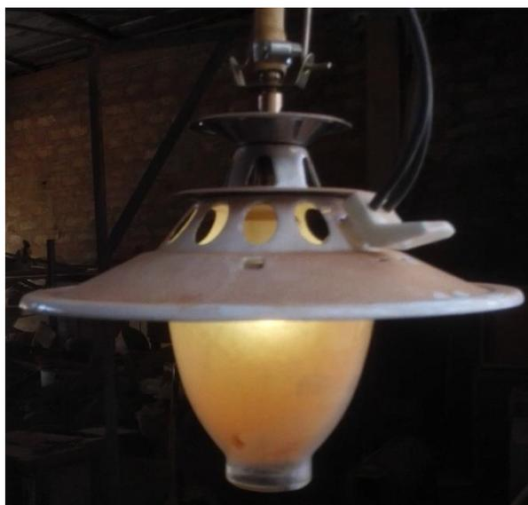
Figure 23 : Lampe à biogaz
