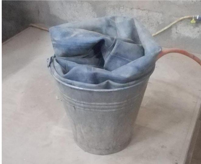
Figure 22 : Estimation du volume des chambres à air vides
