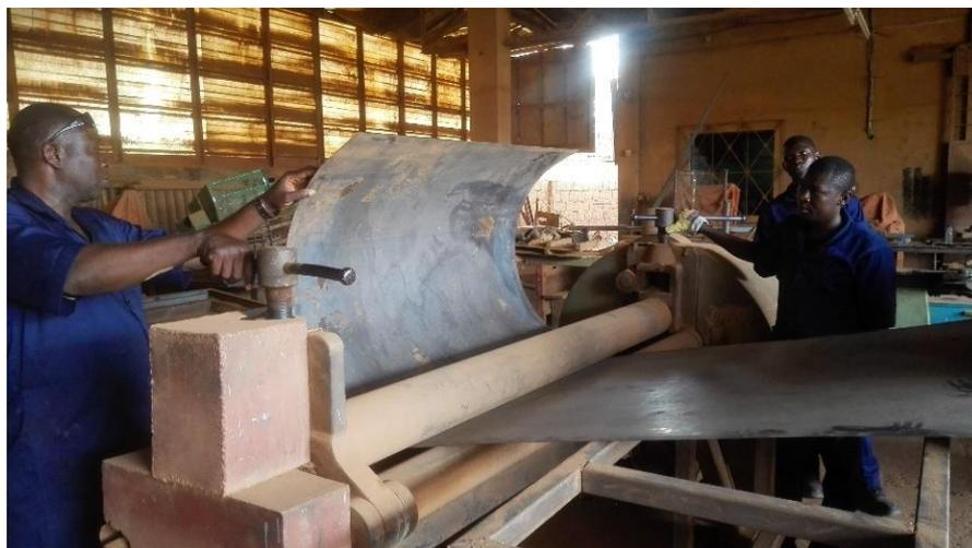
*Figure 39 : Cintrage des tôles métalliques*
