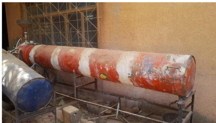
*Figure 10 : Digesteur à 5 fûts réalisé l'an passé au CEAS-Burkina*
