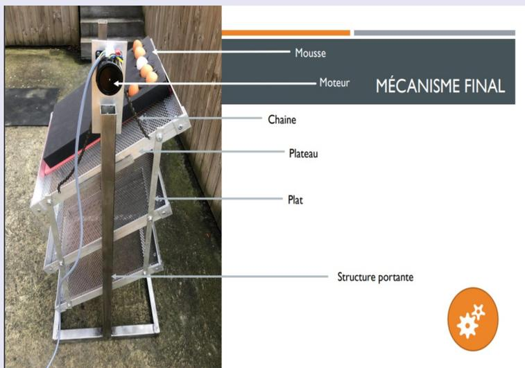
Dans le cadre de leurs travaux de fin d'études, des étudiants de l'Institut Gramme de Liège ont mis au point un mécanisme de retournement automatique et programmable avec possibilité d'être couplé à un système solaire.
